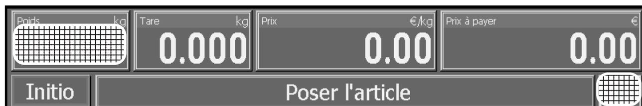
La balance est équipée d'un dispositif de mise à zéro automatique, autrement dit, les petites variations de poids sont compensées automatiquement (par exemple, restes sur le plateau). Ce dispositif de mise à zéro est désactivé lorsque la tare d'un emballage est compensée. Après élimination des saletés sur le plateau, la balance étant sous tension, l'affichage peut indiquer
